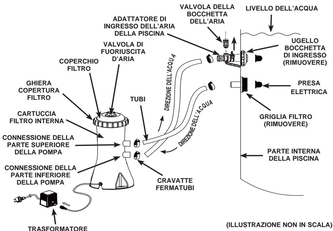
Il filo elettrico che collega la pompa filtro alla presa di corrente a 220-240volt, deve restare a minimo 3,5m dal bordo piscina. Controllare le normative locali per determinare gli standard e i requisiti per "l'installazione dei dispositivi elettrici relativi a piscine e vasche". La seguente tabella è solo indicativa.
