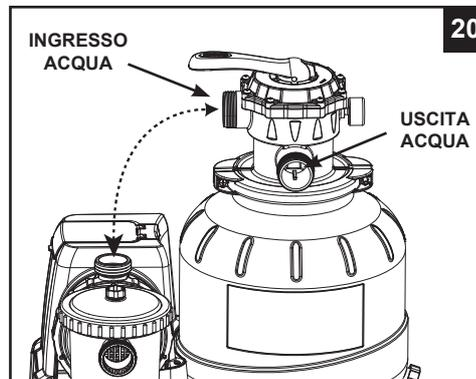
2. Posizionare la guarnizione o-ring a L (11) sulla connessione di ingresso della valvola multi-vie a 6 funzioni. Con un movimento in senso orario collegare il tubo di interconnessione filtro a sabbia (13) tra l'uscita del motore della pompa e la connessione di entrata della valvola multi-vie a 6 funzioni (vedi disegno 21).
