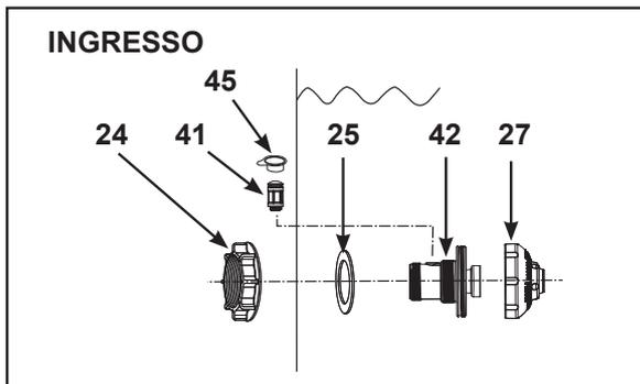
Se la pompa è stata acquistata insieme alla piscina con tubi/raccordo da 38 mm (1-1/2"), sono inclusi i raccordi illustrati di seguito:
