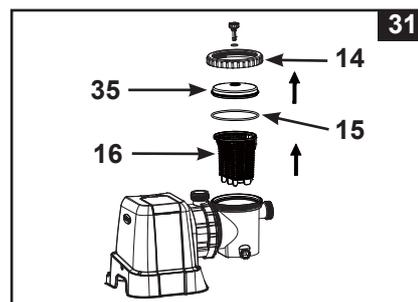
5. Svuotare e scaricare il cestello utilizzando una pompa da giardino, si potrà utilizzare una spazzola di plastica per rimuovere i depositi dal cestello. Non utilizzare una spazzola con punte metalliche.
