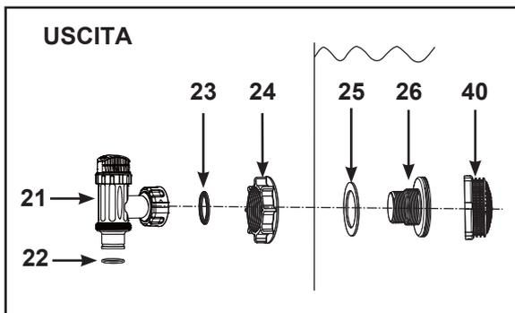
Se la pompa è stata acquistata insieme alla piscina con tubi/raccordo da 32 mm (1-1/4"), sono inclusi i raccordi illustrati di seguito:
